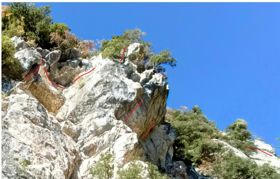
Figura 6: Tipologie di discontinuità
