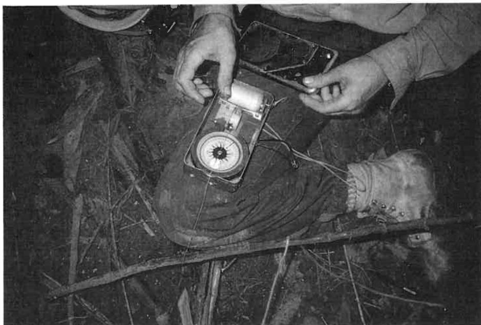
Fig. 2: Il Topofil, utilizzato anche per l'orientamento in foresta
